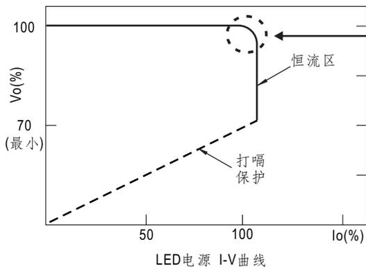
在恒流区,驱动器的最高输出电压取决于终端系统的配置。如有搭配使用问题,请洽询明纬
