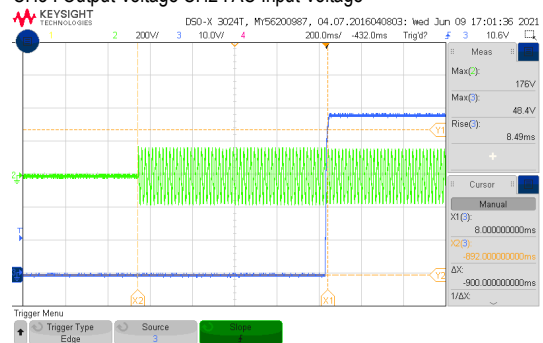
CH3 : Output Voltage CH2 : AC Input Voltage
